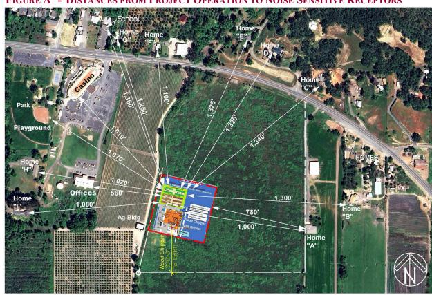
FIGURE A - DISTANCES FROM PROJECT OPERATION TO NOISE SENSITIVE RECEPTORS
